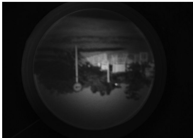
Figura 4 – Imagem formada na câmara escura
