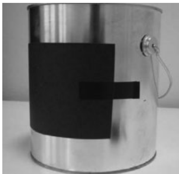
Figura 7 – Máquina fotográfica feita com lata de tinta
