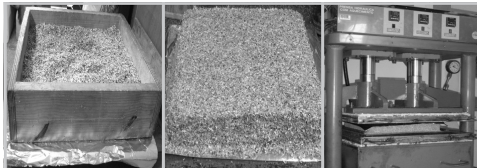
Figura 4 – Da esquerda para direita: Formadora de colchão de partículas, Colchão de partículas, Prensa hidráulica
