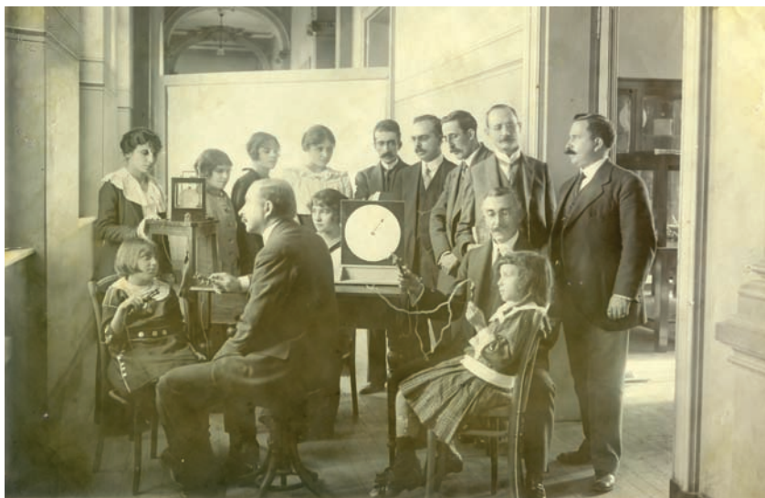
Figura 5 – Professores do Laboratório de Pedagogia Experimental utilizavam os Chronoscópios de D'Arsonval e Pizzoli para medir os tempos de reações a estímulos visuais (à esquerda) e táteis (à direita). (Fonte: Centro de Memória do Instituto de Psicologia)
