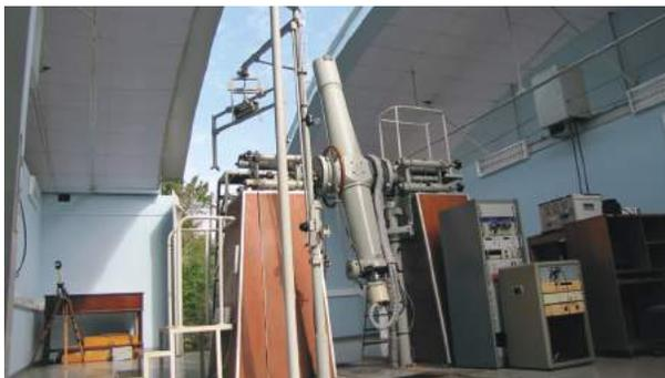
Figura 2 – Telescópio Círculo Meridiano com o detector eletrônico de luz acoplado. Fonte: Acervo do OAM.
