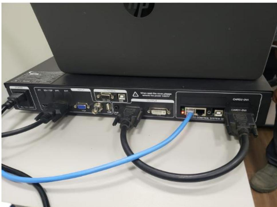
Imagem 6 – ligações cabeadas de equipamento de vídeo para projeção de painel de led da Unidade Móvel
