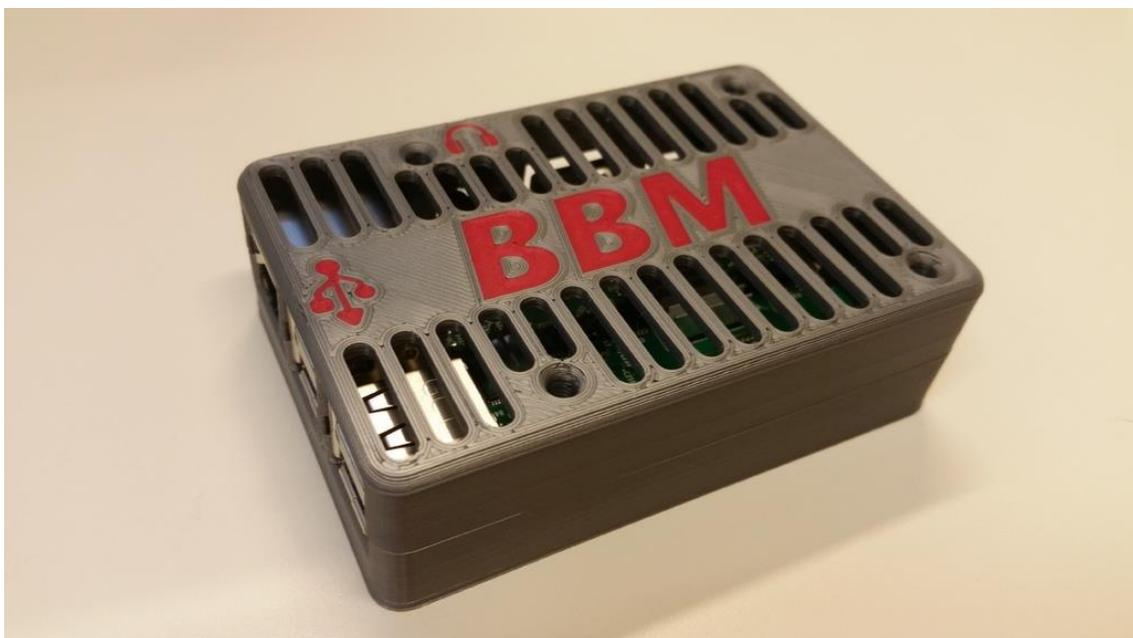
Caixa para acomodação da placa de processamento, impressa em plástico biodegradável.
